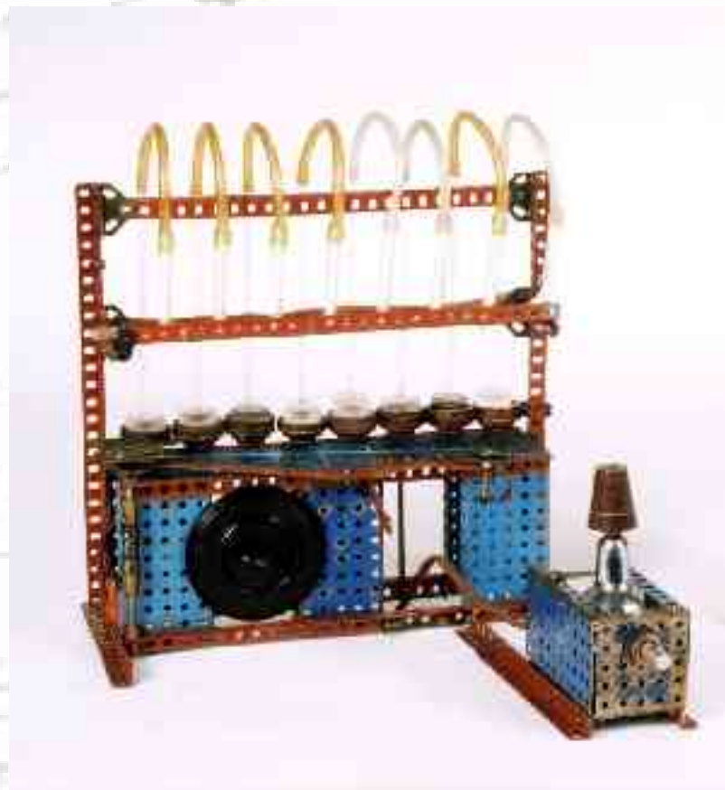
Zařízení na výrobu kontaktních čoček sestrojené z dětské stavebnice Merkur
