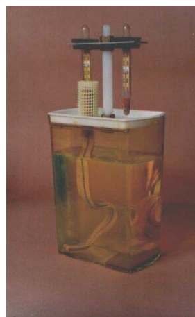
Obr. 4 Stacionerní psychrometr bez vnějšího krytu. 1,5 l dóza z plastu, na jejímž víku je držák s teploměry.
