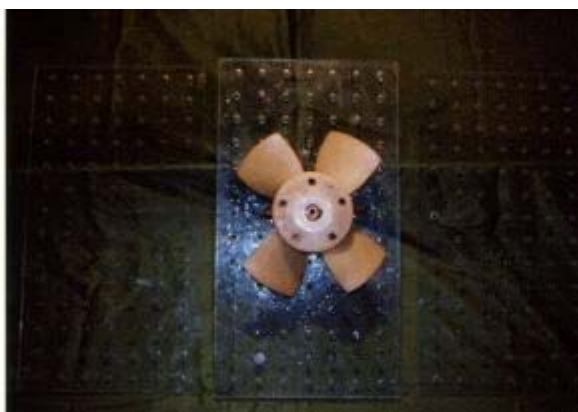
Vrtule (z plastu) instalovaná na perforované dno zespodu
